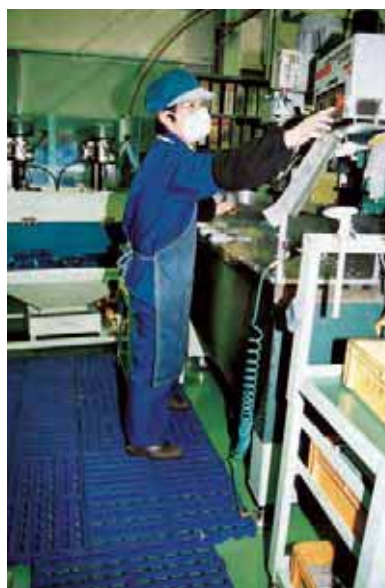
▲ 操作ボタンや作業台が高く、作業がしづらかったので床にパレットを敷き作業面の高さを調節した。
