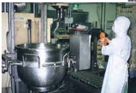
◀▶ 釜の中を清掃する際、釜を傾げるのにクレーンを使うようにした。
