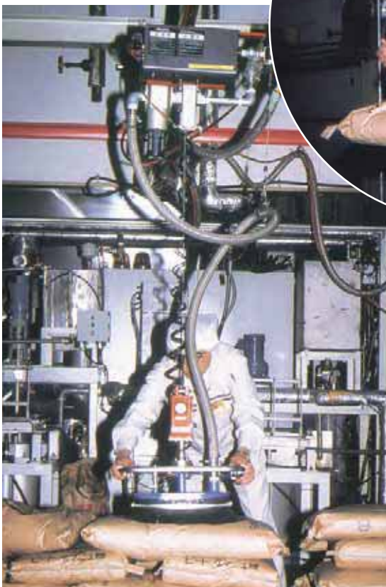
△作業員が人力で原料を仕込み釜まで持ち上げて運搬していたが、バキュームホイストを導入して楽に運搬できるようになった。
