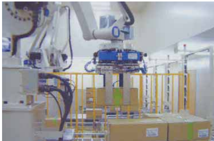
△商品の積み上げ作業を自動化し、重筋作業をなくした。
