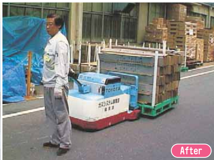
▶ 人力によるジャッキを使用していたが、腰にかかる負担が大きく腰痛が発生していたため電動ジャッキを導入した。
