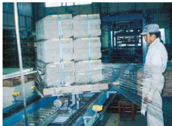
▲ 瓦の周りを作業者が中腰になりフィルムを巻き付けていた作業を、ターンテーブル上でパレットごと瓦を回転させるように変更し、負担の大きかった中腰での無理な作業を解消した。
