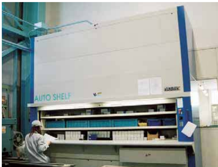
▲ 部品の収納に自動回転ラックを導入し一定の高さから、出し入れできるようにし不良姿勢を改善した。
