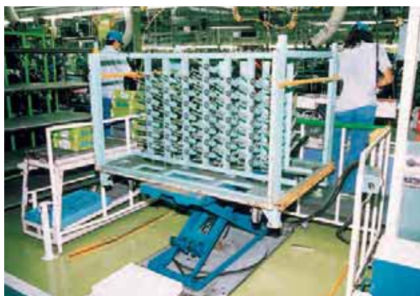
▲ 昇降式の部品棚を採用して楽な姿勢で部品を取り出せるようにした。
