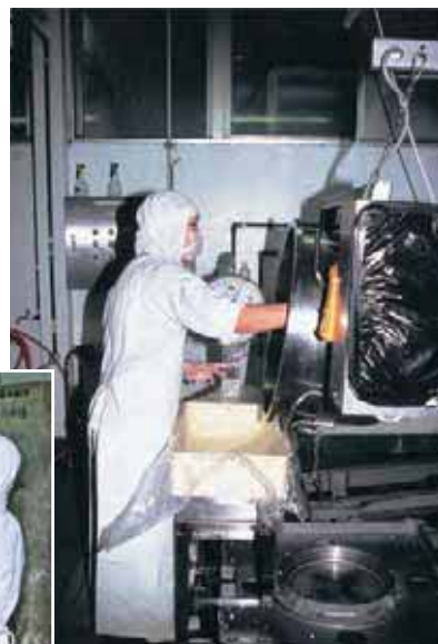
◀▶ 釜の中を清掃する際、釜を傾げるのにクレーンを使うようにした。
