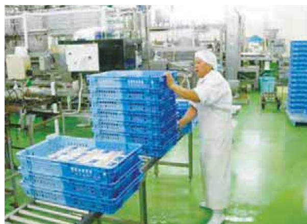
▶ ローラーコンベアを利用して、製品をスムーズに安全に運搬できるようにした。
