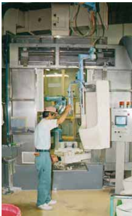
▶ 製品を塗装ブースに運ぶ助力装置を導入した。
