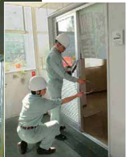
▲ 空気環境の測定 (気流の風速)
