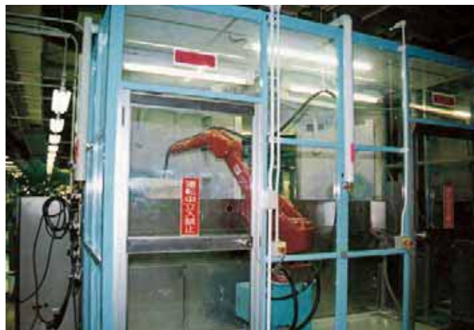
▲衛生陶器の下地の吹き付け作業を密閉されたブース内で自動化し、下地塗料の拡散をなくした。
