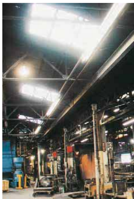
▲暗くなりがちな工場内に天窓を設け自然光を取り入れるようにした。
