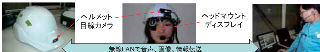
無線LANで音声、画像、情報伝送 IT各機能の統合組込ヘルメット 高精細目線カメラと眼前ディスプレイ 遠隔からの(一人)作業支援
