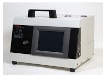
図-26 粉じん相対濃度計の構造の例
