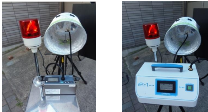
図-31 排気ダクト内の測定時に警告灯を設置した例
