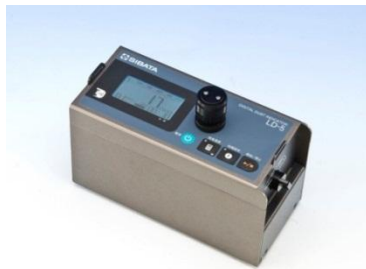
図-25 吸引ポンプ内蔵の粉じん相対濃度計の例
