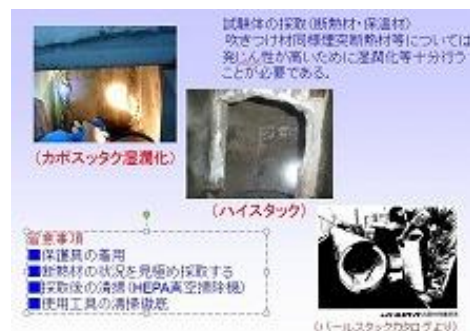
図-3 サンプルング例（煙突断熱材）
