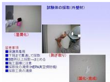
図-4 サンプルング例（外壁材）
