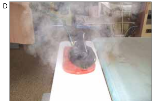
D このような状態では石綿ばく露は皆無でしょう。ただしクリーニング店には、この他に乾燥器など断熱材の使用箇所はかなりあり、劣化による飛散や、修理・補修時等のばく露の可能性もあります。
