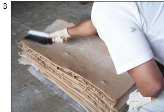
B ゴムにハケでタルクを塗っているところ。タルク粉をまんべんなく塗っておかないと、ゴム同士がくっついてしまいます。塗布する際にはタルクが飛散した可能性があります。
