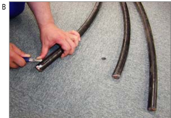
B 地中送電高圧用の電線。昔の電線はここに石綿紙が使われていました。石綿紙だから絶縁性や柔軟性がありますが、薄くて強度がないのでゴム等で更に補強しています。
