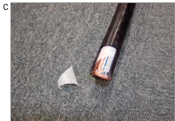
C 左の写真の表面皮膜をはいだところ。写真の絶縁紙はノンアス品ですが、以前は石綿紙が使用されており、修理や交換の際に作業員がばく露した可能性があります。
