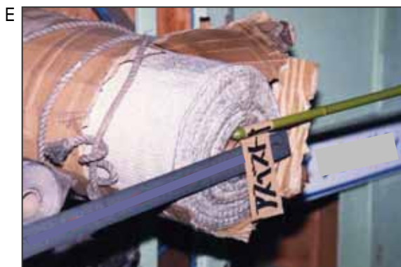
工場内の各工程毎に置かれた石綿布。必要な際にすぐに使えるように各所に置かれていました。石綿手袋も各工程に常備されガラスを取り出す際に使用しました。
