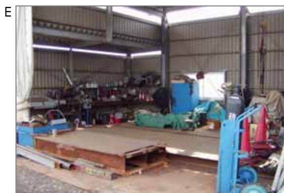
町の鉄工所はこんな雰囲気です。溶断・溶接が多いので石綿布はかかせませんでした。また建物は石綿スレート使用が多くみられます。
