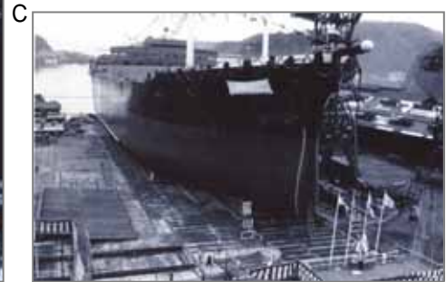
C 進水。1959年。船はドックから進水し岸壁で船内他の整備(ぎ装)が続きます。
