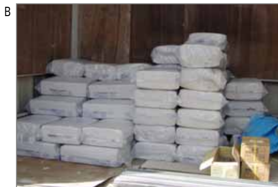
B 吹きつけ綿の在庫(写真は岩綿材)。最近30年間は、同じような梱包形態です。袋が運搬途中に破れて、商品の運搬に携わった運転手がばく露する可能性があります。
