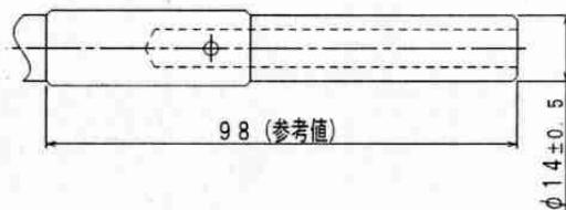
図2 据え込み式止め金具
